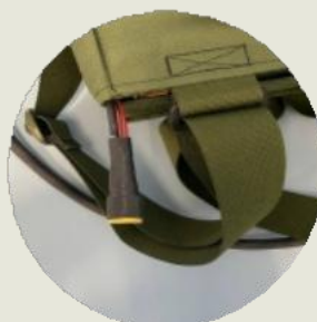
1.2 Выведен порт XT60 (папа) для подключения дополнительного АКБ
